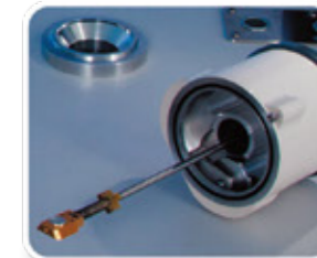
クライオトランスファーデバイスと、シャトルおよびスタブインサート
