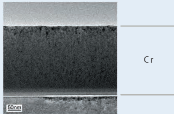
Cr 被膜 (約 300nm) の断面 TEM 像
