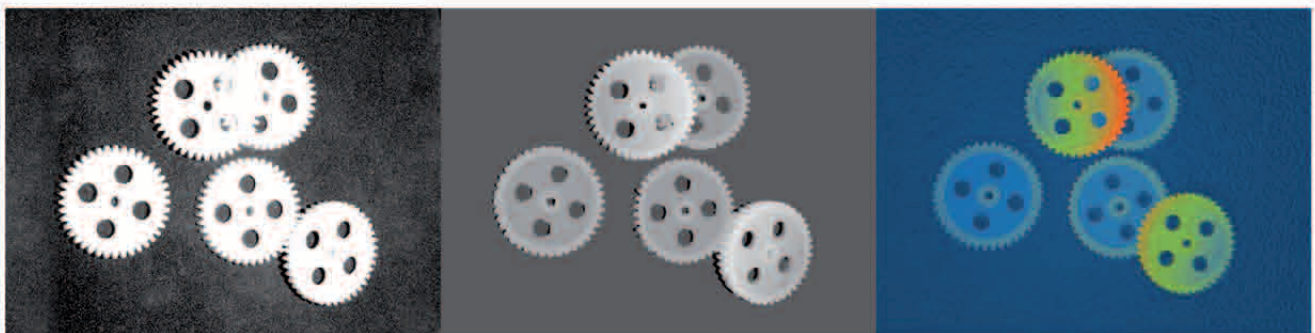
▲ 2D画像、グレースケールのコード化されたエリアマップ、3Dポイントクラウドとして、直接出力されるAreaScan3Dデータ
