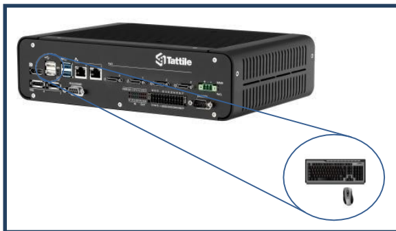
ステップ 3 - USB マウスとキーボードを 接続 (par. 2.3.8を参照)
