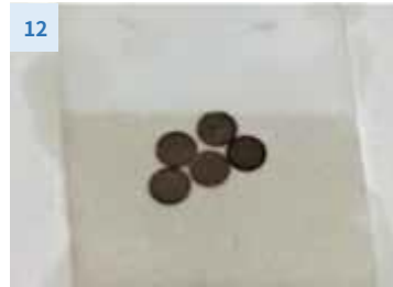
12 マイカから剥離したカーボンで覆われた TEM グリッド ( 5 \times 10^{-7} 、 7 \times 10^{-7} mbar の真空中で蒸着)
