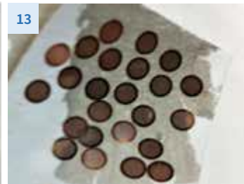
13 真空中 4 \times 10^{-5} mbar で調製した 10 nm カーボンで覆われた TEM グリッド、カーボン層に亀裂が見られる
