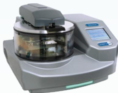
大型・複数試料のスパッタ / 2 元ターゲットでの連続スパッタ
