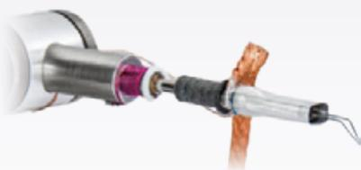
LN2 温度まで冷却できるクライオ互換バージョンのマイクログリッパーです。グリッパーは、断熱ホルダを使用してマイクロマニピュレータ MM3A-EM に取り付けられます。グリッパーは顕微鏡のクライオシステムに接続して冷却されますが、断熱ホルダによりマイクロマニピュレータは室温に保たれます。
