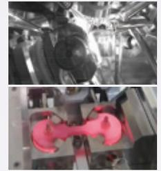
ソフトウェアで制御しながら引張試験を行なうステージです。金属ヒーターを用いて 1000°Cまで加熱できます。セラミックスを使用しないため高温下でのガス発生がありません。熱電対で試料部とステージの温度をモニタします。ガス環境下でも使用可能なステージです。SEM や光学顕微鏡 (ラマン分光など) との組み合わせで変形をその場観察するのに最適です。
