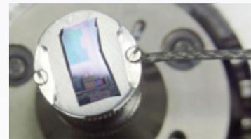
SEM/FIB に小型加熱ステージを追加するためのスタンドアロンシステムです。MHS には、付属の温度制御システムを使用して設定された温度を維持するために、統合された加熱・検知システムが搭載されています。
