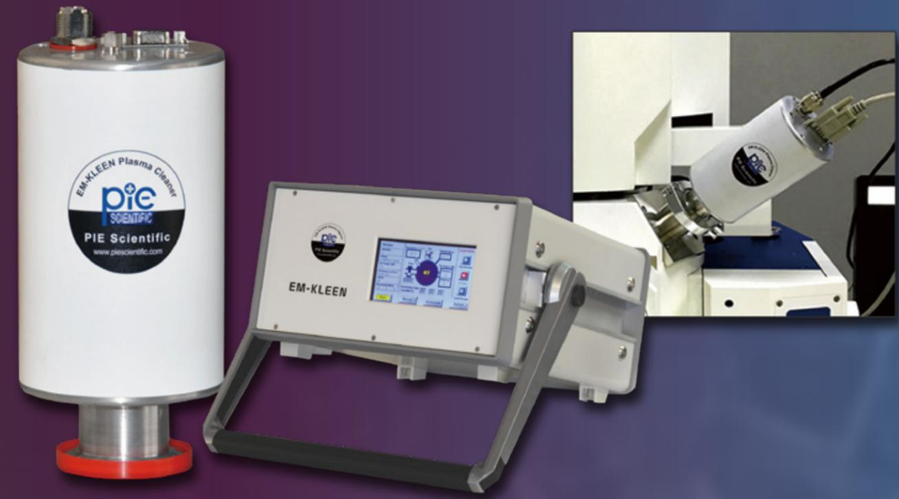
分離されたプラズマソースとコントローラで構成され、ソースは FE-SEM や XPS, EPMA などの試料チャンパーもしくは試料交換室などに接続されます。
