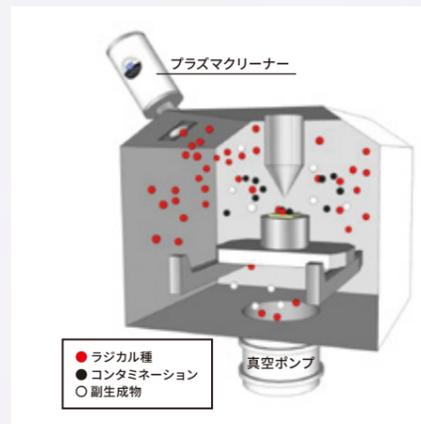
\* 通常は Air または酸素ガスをプロセスガスとして導入することで酸素ラジカル（原子状酸素）を生成し、酸化反応によりクリーニングを行います。酸化が許容できない場合は、ガス種に水素を用いた水素プラズマ（原子状水素）による還元反応でクリーニングする場合があります。
